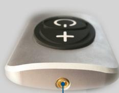
Conecte a antena aqui
